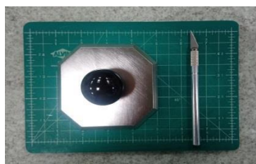
Figura 7 - Gabarito para PERMATRAN-W 3/34 e OX-TRAN 2/22 (MOCON®)
