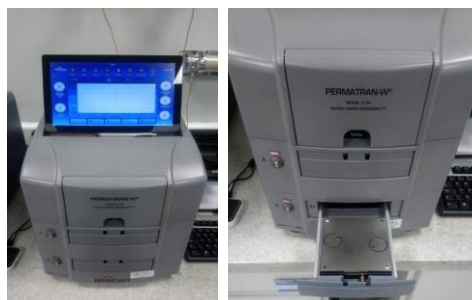
Figura 6 - Equipamento Mocon® Permatran-W 3/34. Visão geral à esquerda (A) e célula de difusão inferior (B) à direita
