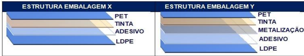
Figura 4 - Estrutura de laminação
