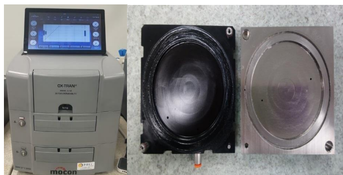
Figura 9 - Equipamento Mocon® OX-TRAN 2/22 (A) à esquerda e células de difusão (B) à direita
