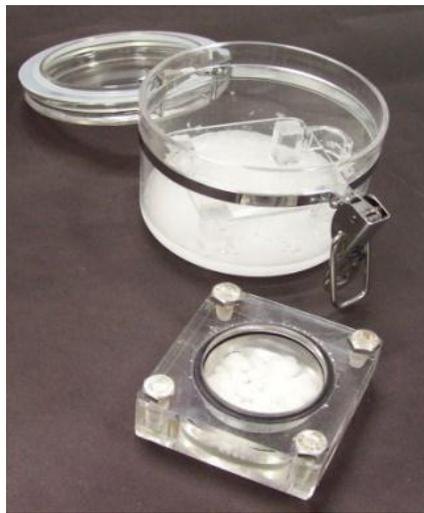
**Figura 4.** Aparato experimental utilizado para determinação da permeabilidade ao vapor de água.
