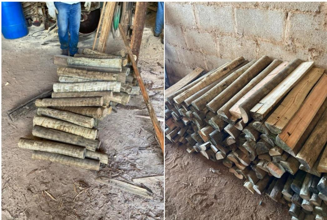
**Figura 4.** Travessas centrais da cruzeta após o corte na serraria.
