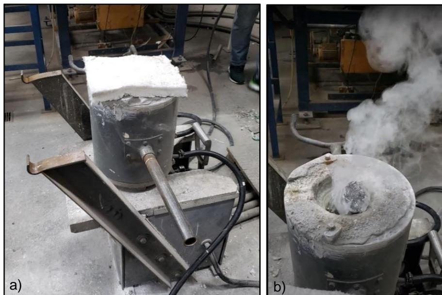
**Figura 11:** a) forno de indução utilizado para fusão dos briquetes. b) fumaça de queima.
