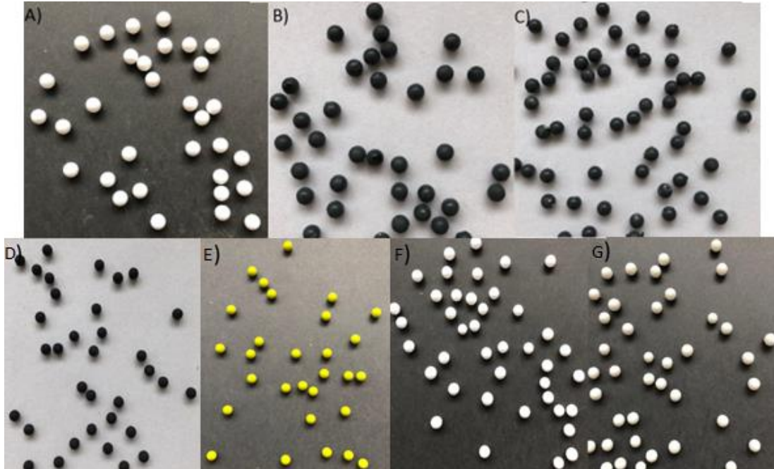
Figura 15 – ABS sem revestimento (A), ABS com uma camada de revestimento (B), ABS com duas camadas de revestimento de borracha (C), fluorelastômero (D), borracha nitrílica (E), alumina (F) e porcelana (G).
