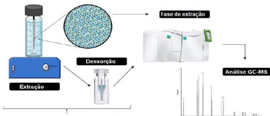
Figura 6: Esquema de extração por membrana (MMLLE), adaptado de (PEREIRA-COELHO et al., 2021).
