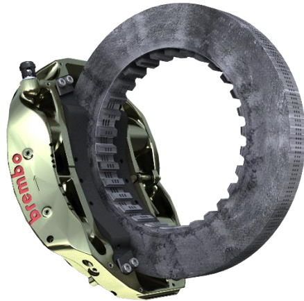
Figura 135 - Conjunto Disco, Pinça e Pastilhas da Fabricante Brembo utilizada na Fórmula 1
