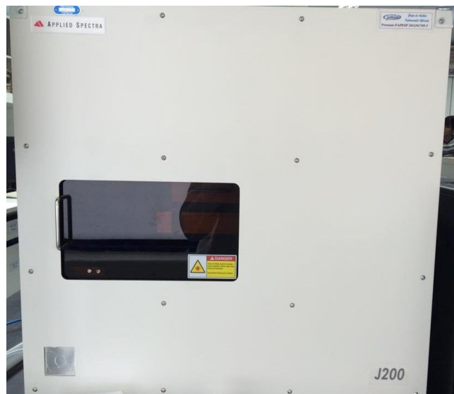
FIGURA 4.2.1- Visão geral do equipamento LIBS J200 da Applied Spectra. A maçaneta frontal dá acesso ao porta-amostra.
