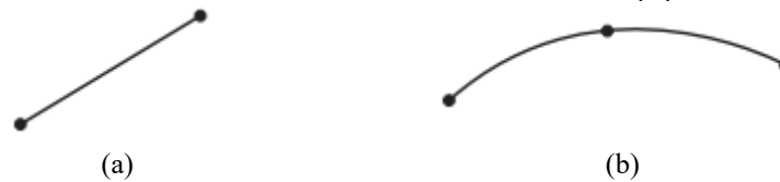
Figura 3 – Elementos unidirecionais com dois nós (a) e três nós (b)
