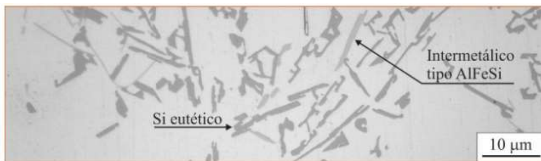
Figura 2.17 Microestrutura da liga Al-7%Si-20%Zn solidificada fora do equilíbrio com destaque para as fases Si e AlSiFe nas regiões interdendríticas em relação à matriz \alpha -Al [93].
