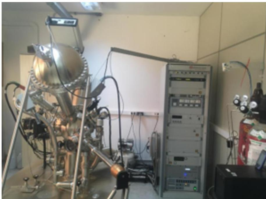
Figura 3.6 - Espectrômetro de raios-X da marca Scienta-Omicron, modelo ESCA +, instalado no NACa – FCM-IFSC-USP.
