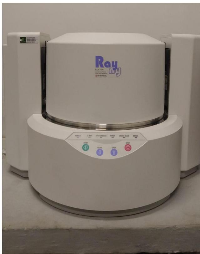
Figura 3.4 – Espectrômetro de fluorescência de raios-X Shimadzu 720, instalado no IFMS.
