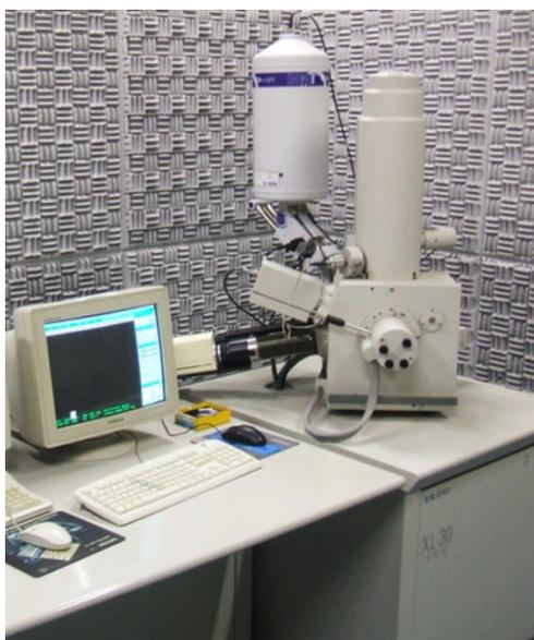
Figura 3.3 – Microscópio eletrônico Phillips XI-30 FEG, instalado no LCE/UFSCar.
