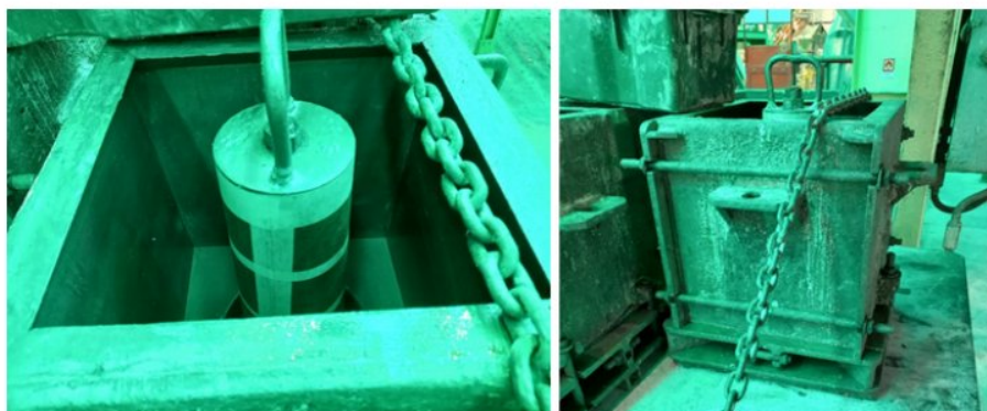
Figura 10 — Exemplo de forma para sede de plugue já com o macho posicionado.
