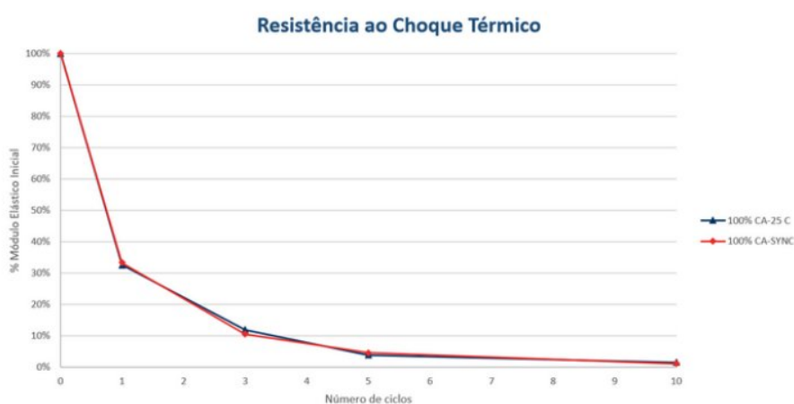
Figura 26 — Módulo de elasticidade residual em função dos ciclos de choque térmico
