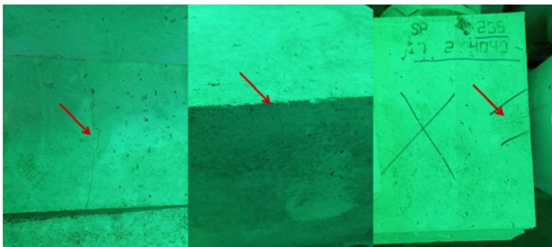
Figura 1 — Sedes de plugue trincadas
