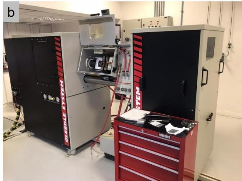
Figura 4.2 (continuação). Simulador termomecânico *Gleeble*<sup>®</sup> 3800. Em (a) visão geral do simulador com o sistema digital de controle à esquerda e em (b) visão do módulo de testes com a câmara contendo as garras de fixação dos corpos de prova.
