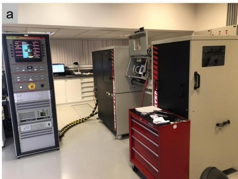
Figura 4.2 Simulador termomecânico *Gleeble*<sup>®</sup> 3800. Em (a) visão geral do simulador com o sistema digital de controle à esquerda e em (b) visão do módulo de testes com a câmara contendo as garras de fixação dos corpos de prova.
