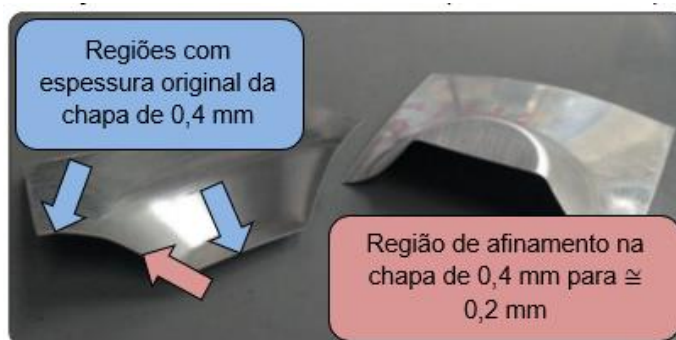
Figura 63 – Espessura da chapa de pois de deformada.
