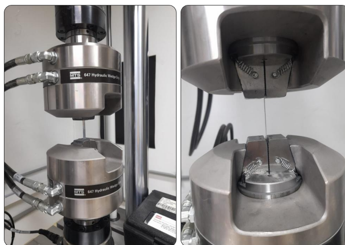
Figura 29 – Garras de fixação e corpo de prova durante o ensaio de tração na máquina MTS Landmark .
