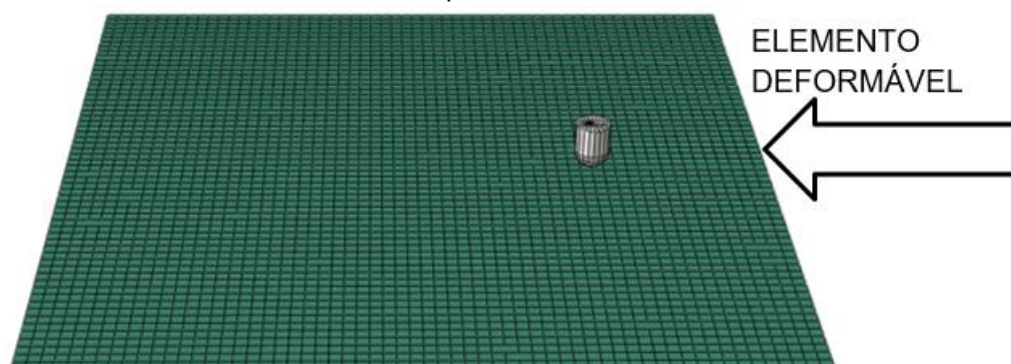
Figura 45 – Elementos de malha da chapa de alumínio para análise do modelo computacional.
