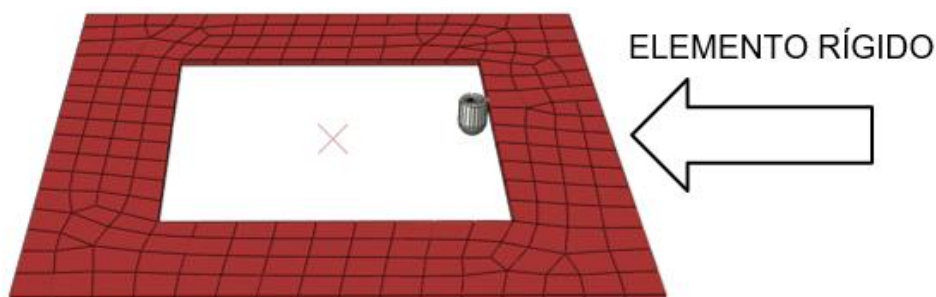
Figura 44 – Suporte prensa chapas modelado no software do método de elementos finitos ABAQUS®.
