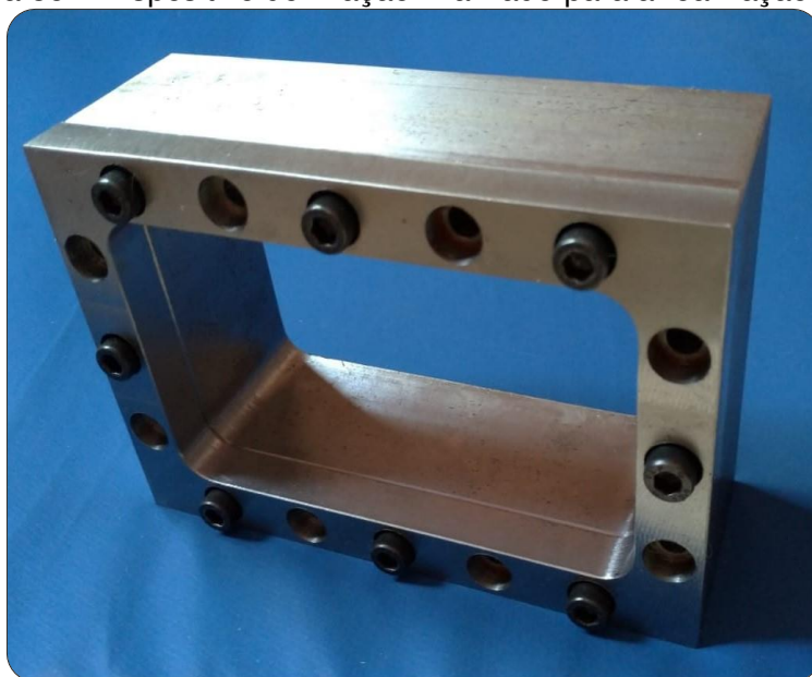
Figura 35 – Dispositivo de fixação finalizado para a realização da EI.
