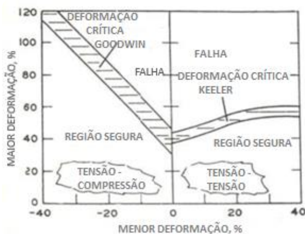
Figura 16 – Diagrama limite de conformação elaborado em 1968 por Goodwin e Keller.
