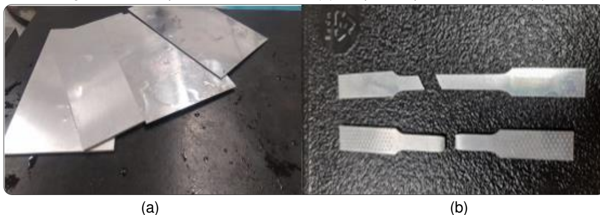
Figura 28 – Chapas de alumínio 2024 (a), corpos de prova ensaiados (b).
