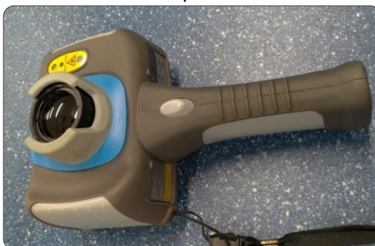
Figura 39 – Câmera termográfica para acompanhamento dos valores da temperatura durante os experimentos.
