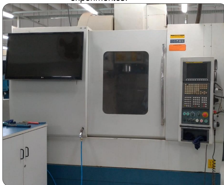
Figura 31 – Centro de usinagem CNC Romi D800 utilizado para a execução dos experimentos.
