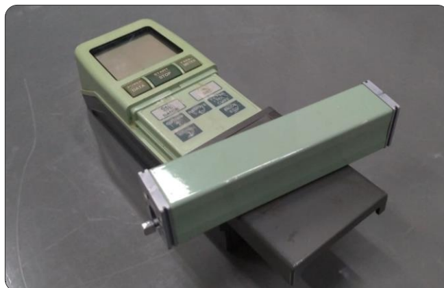
Figura 40 – Rugosímetro utilizado para aquisição dos parâmetros de rugosidade dos experimentos.
