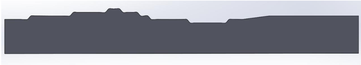
Figura 11 – Exemplo de superfície do trecho do rebolo (0,1 mm de largura) projetada no CAD a partir da curva extraída do microscópio
