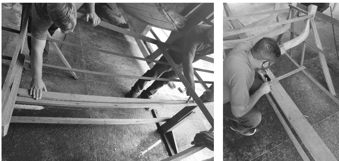
Figura 39 - Tirando as medidas para determinar a posição das cavernas
