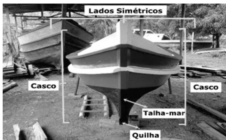
Figura 38 - Simetria existente na embarcação
