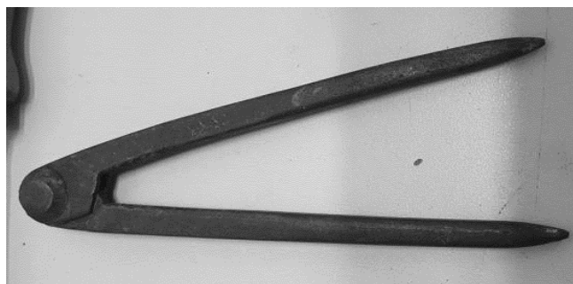
Figura 45 - Compasso de ferro usado pelos carpinteiros navais
