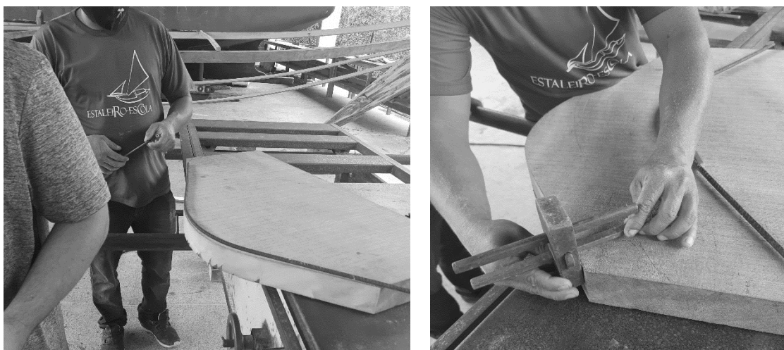
Figura 41 - Manuseio do graminho para determinar a largura da caverna
