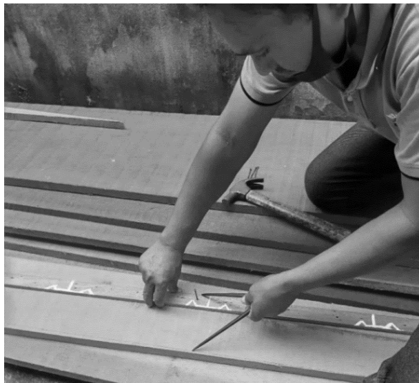
Figura 46 - Transferindo os pontos de fasquia para a tábua
