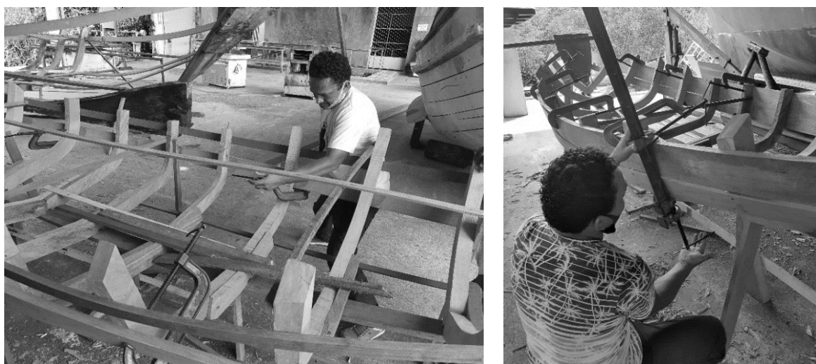
Figura 43 - Assentamento do tabuado da embarcação
