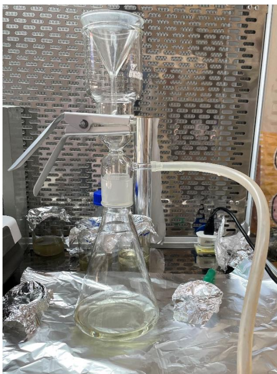
FIGURA 4.8 - Equipamento de filtração utilizado para filtrar amostras após os processos de degradação de matéria orgânica e de separação por densidade.
