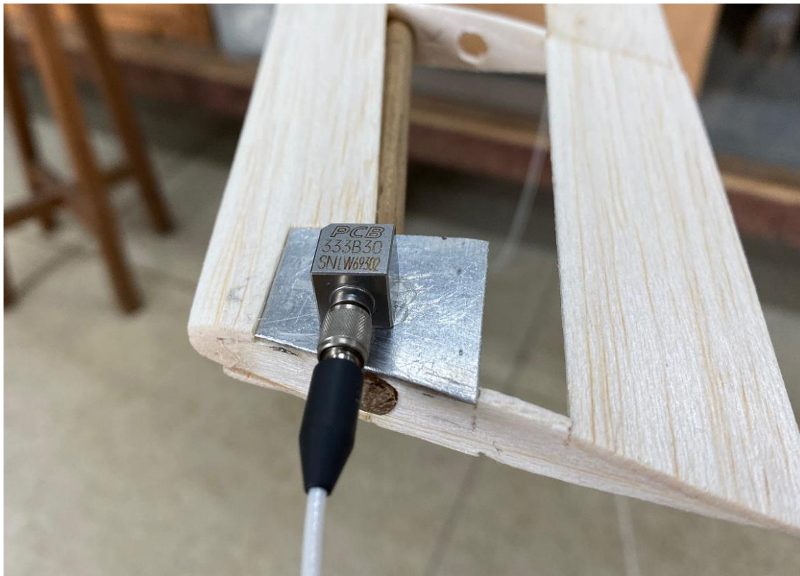
Figura 22: Acelerômetro PCB Piezoelectronics 333B30 na extremidade da asa.
