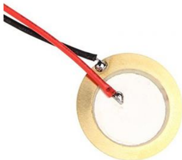
Figura 18 - Pastilha piezelétrica utilizada como transdutor de vibração.
