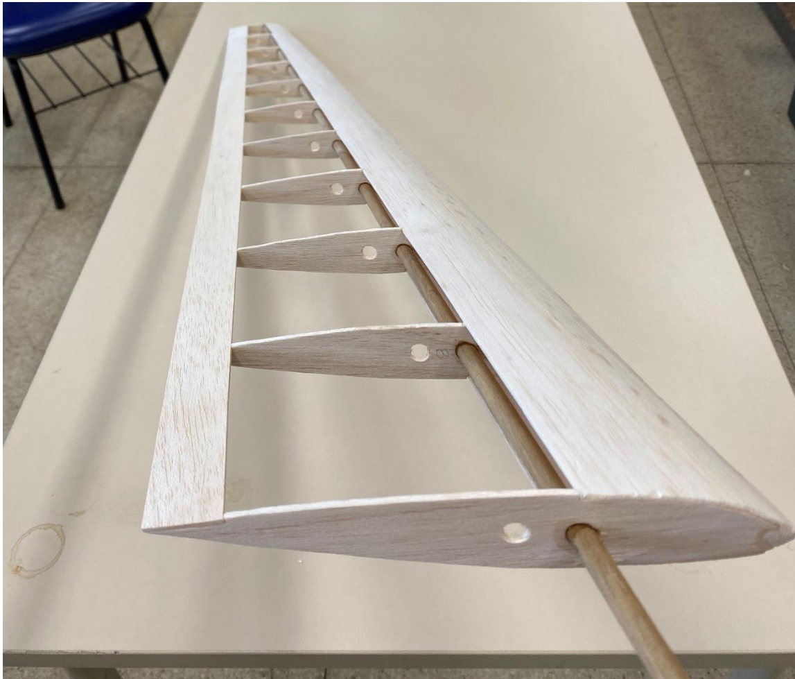
Figura 14 - Protótipo da asa – vista lateral.
