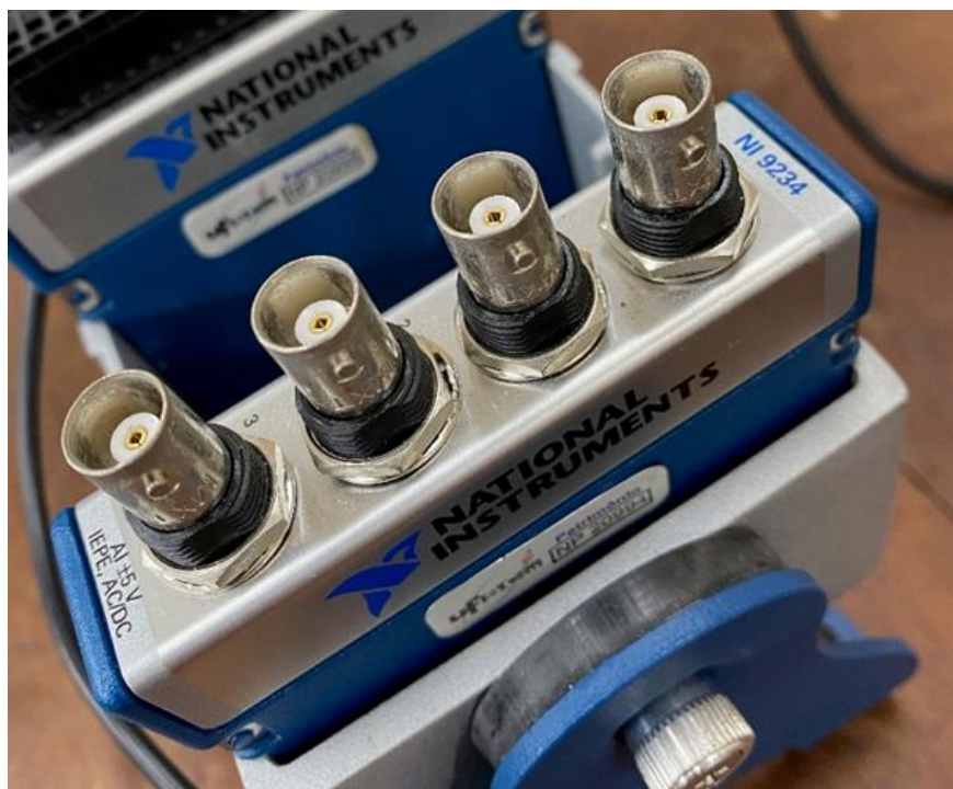
Figura 20 - Sistema de aquisição de sinais NI-9234 utilizado na coleta de dados experimentais.
