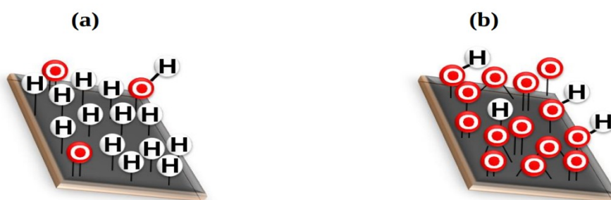
FIGURA 1.3 - Representação da superfície do BDD com as diferentes terminações (a) hidrogenadas e (b) oxigenadas. Fonte: ref. 54.
