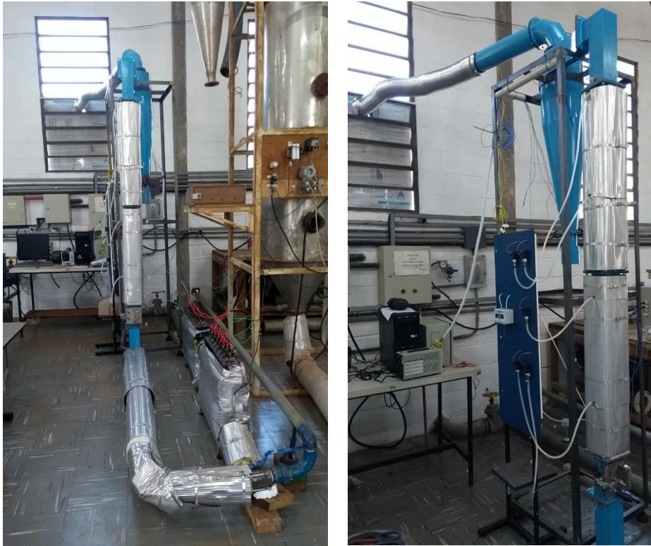
Figura 29 - Fotografias do equipamento de secagem de minério de ferro GR-1, construído no Centro de Secagem de Pastas, Sementes e Suspensões, do DEQ/UFSCar.
