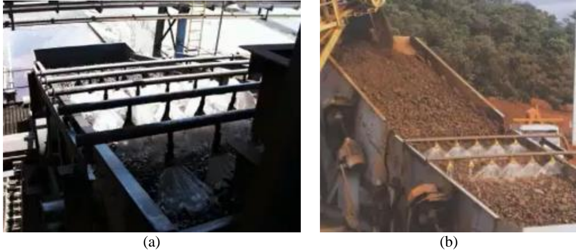
Figura 3 - Peneiramento a úmido: fotografias de peneiras industriais de minério.
