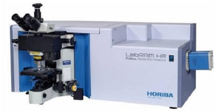
Figura 32: Foto do sistema LabRam HR UV-Visível-NIR utilizado para medidas de Raman e Fotoluminescência a temperatura ambiente. Retirado de http://www.bv.fapesp.br/pt/auxilios/84919/centro-de-caracterizacao-de-novas-especies-minerais-espectroscopia-raman-difracao-por-raios-x-e-neut/
