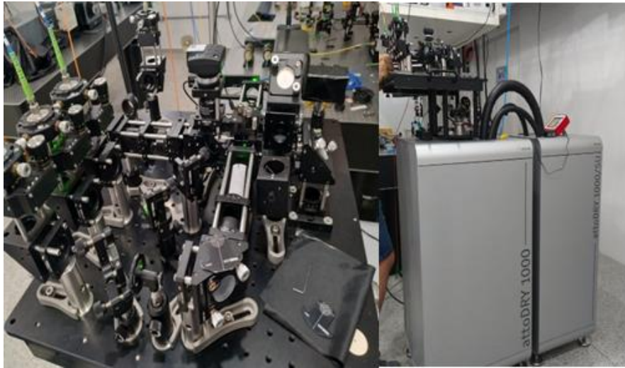
Figura 31: Fotos do sistema utilizado para medidas de magneto fotoluminescência em baixa temperatura AttoDRY1000.
