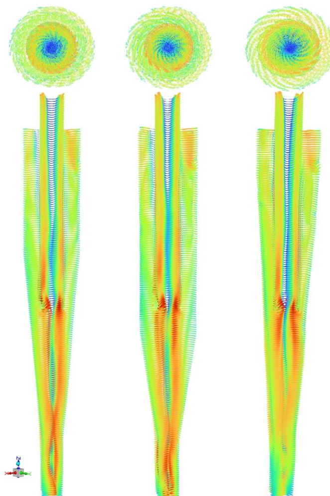
Figura 36 - Ilustração vetorial do fluxo rotativo do gás para os três ciclones, destacando a formação do vórtex gasoso interno, na condição operacional de 3,21 m/s.
