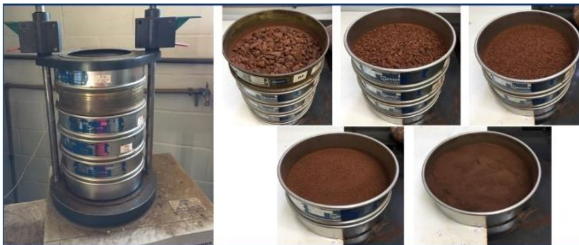
Figura 10 - Ilustração do procedimento de aquisição da fração fina do minério de ferro.
