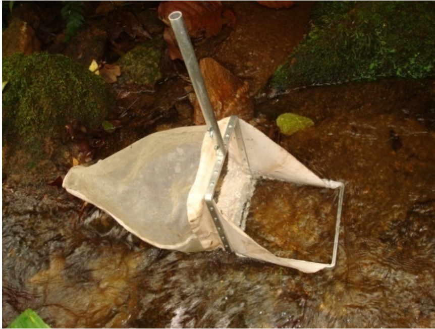
Figura 02. Amostrador de Surber modificado (área de 0,0361m 2 , malha 0,25 mm).
