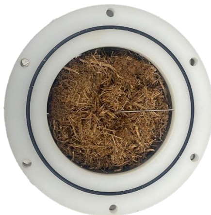
Figura 4.8. Posição do termopar para acompanhamento da temperatura.
