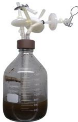
Figura 5.10. Sistema utilizado no cultivo submerso, imagem real ao final do tempo de 96 h.
