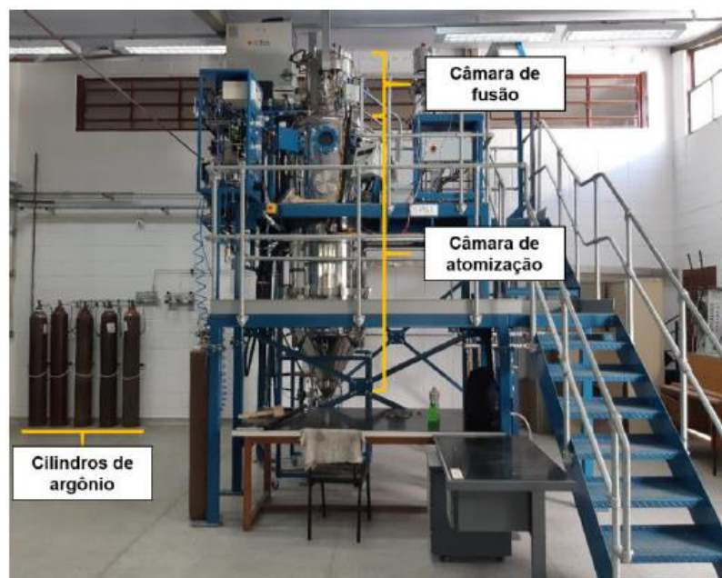
Figura 3. 2-Atomizador a gás HERMIGA 75/5VI (EAC) - PSI Phoenix Scientific Industries do Laboratório de Atomização e Revestimento do DEMa/UFSCar.
