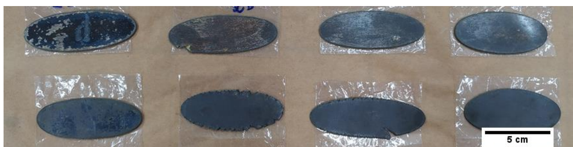
Figura 3.3 - Aspecto das ligas após laminação a quente e solubilização.
