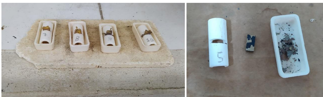
Figura 4.12 - Destacamento da camada de óxido após oxidação a 1.000 °C. Obs.: Amostras 7 e 8 - Nb10 após 48 h; amostras 9 e 10 - Nb12 após 48 h e; amostra 5 - Nb9 após 24 h.
