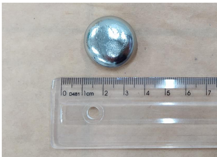
Figura 3.2 - Aspecto das ligas após fusão em forno a arco eletro-voltaico.
