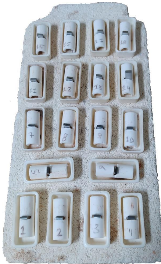
Figura 3.4 - Conjuntos cadinho/suporte/amostra dispostos sobre o refratário.
