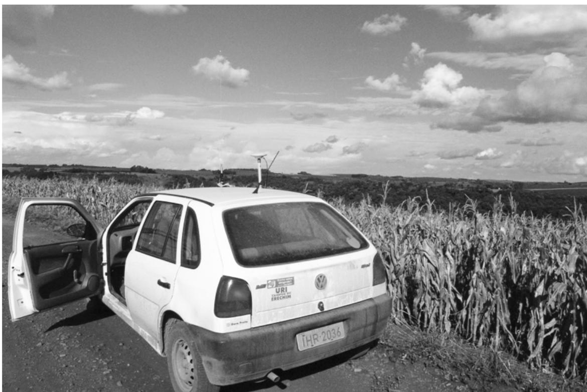
**Figura 17:** Método de atualização viária – Navegação em tempo real e coleta de coordenadas de GPS topográfico (Leica SR20), para ajuste e georreferenciamento de imagem de satélite, evidenciando estrada rural de menor fluxo. (DECIAN, 2011).
