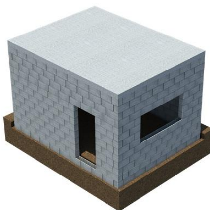
Figura 7 - Modelo esquemático de alvenaria estrutural
