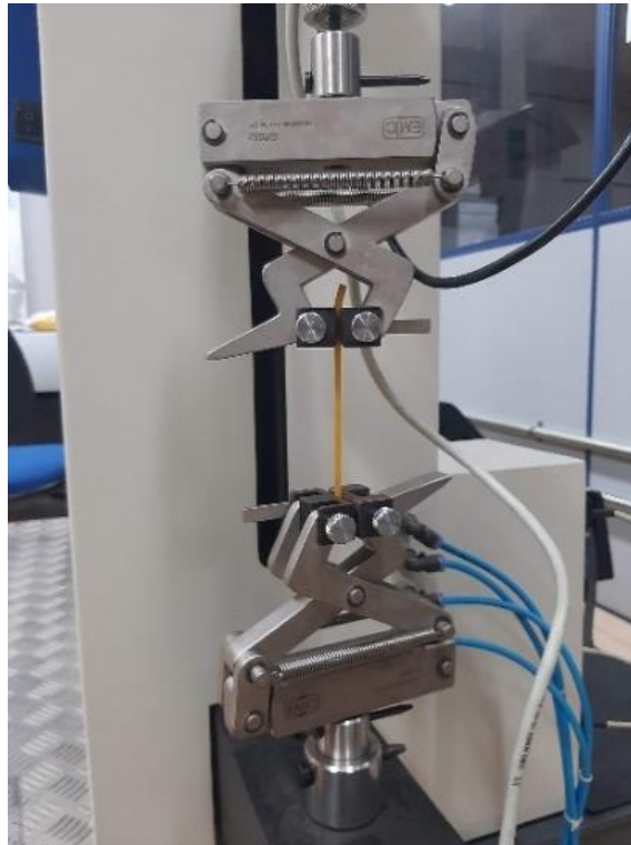
Figura 4-2 Máquina Universal de Ensaio com adaptador acoplado e amostra a ser ensaiada.
