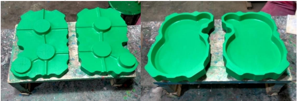
Figura 29 - Modelos de fundição da carcaça do transmissão do “M8”
