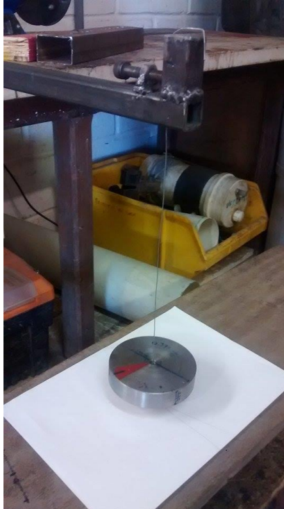
Figura 21 - Experimento da oscilação do pêndulo de torção
