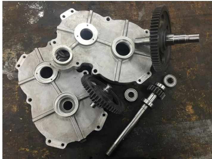
Figura 30 - Carcaça, engrenagens e eixos do redutor do “M8” pós-fabricação
