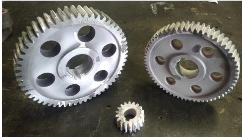
Figura 11 - Engrenagens do redutor do “Moisés” após ensaio de líquido penetrante
