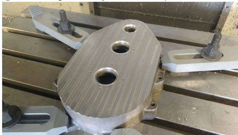
Figura 13 - Usinagem da carcaça da caixa de redução do “Moisés” no LPF
