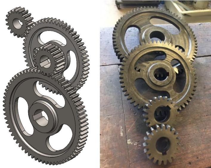
Figura 25 - Engrenagens da transmissão do protótipo "M8"
