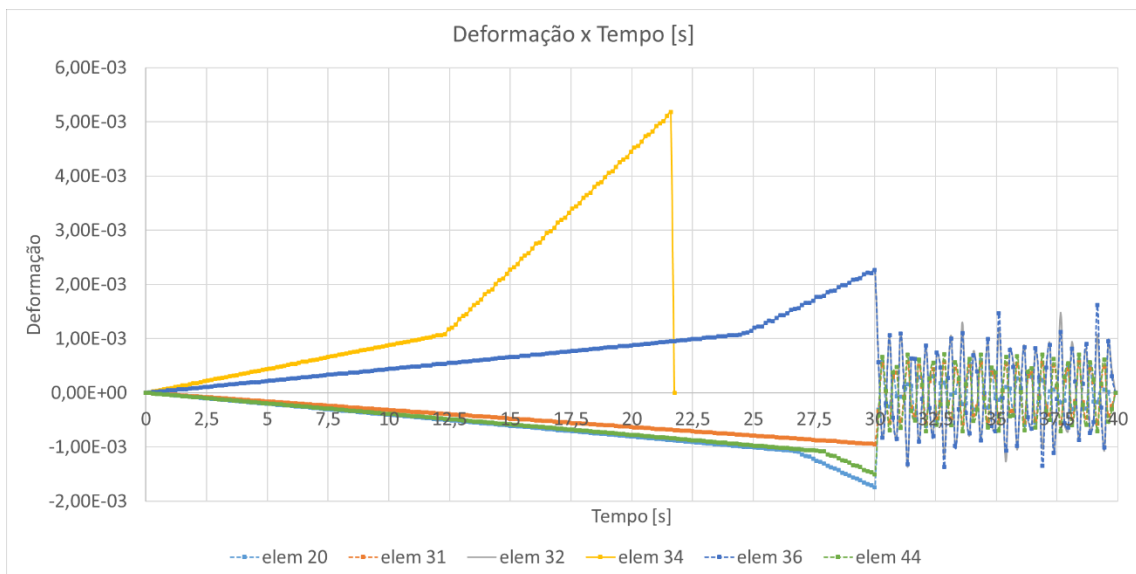
Figura 50 – Curvas de deformação x tempo – Aço estrutural galvanizado S235 W com efeito de corrosão
