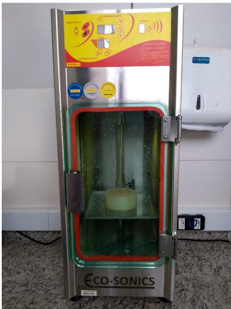
FIGURA 7 – Sonicador Ultrassônico, Ultronique QR 500, potência *ultrassônica* 500 watts.
