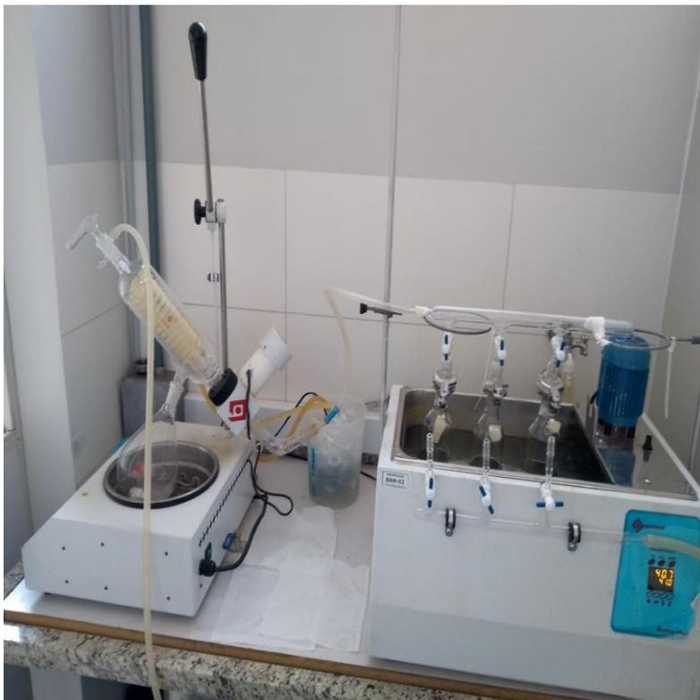
FIGURA 8 – Sistema de concentração composto por um banho-maria associado a um sistema de vácuo e recuperação de solvente por condensação.
