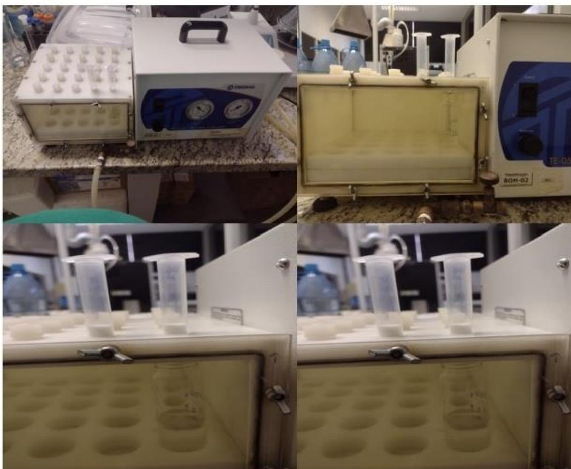
FIGURA 6 – Sistema *manifold* para extração em fase sólida com cartuchos
