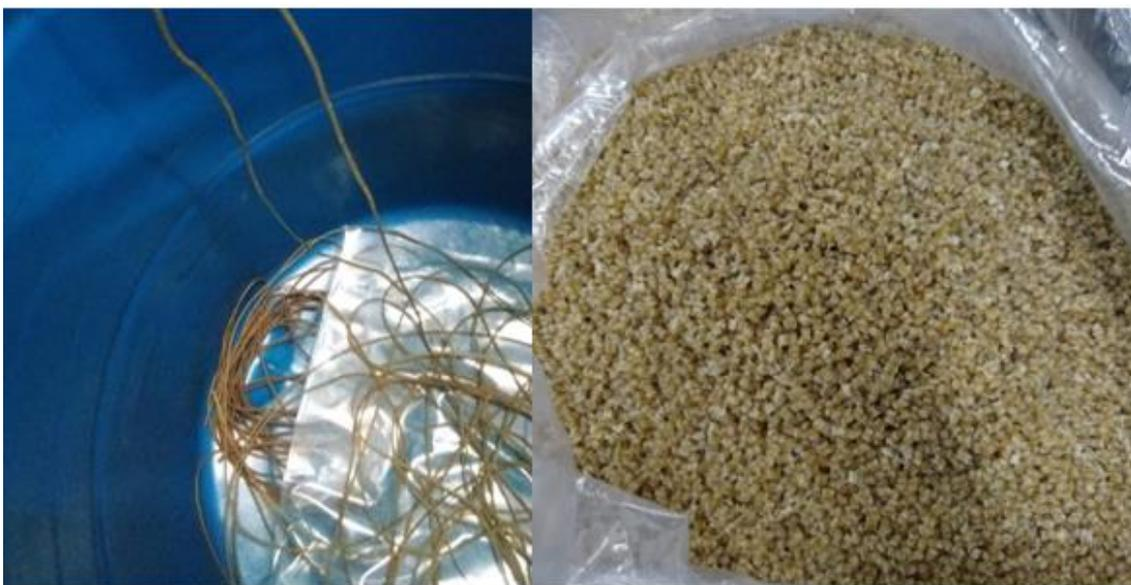
Figura 3.4 – Filamentos e Pellets de TPF.
