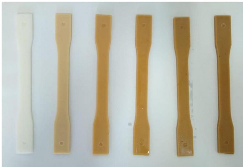
Figura 3.7 – Corpos de prova tipo I obtidos por injeção (0 a 50% de TPF, da esquerda para a direita).
