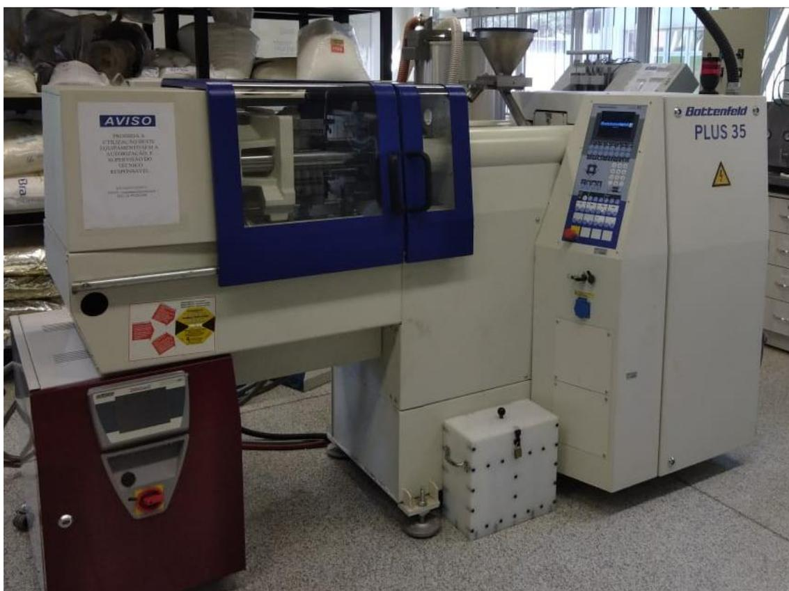
Figura 3.6 – Injetora utilizada para obtenção dos corpos de prova.
