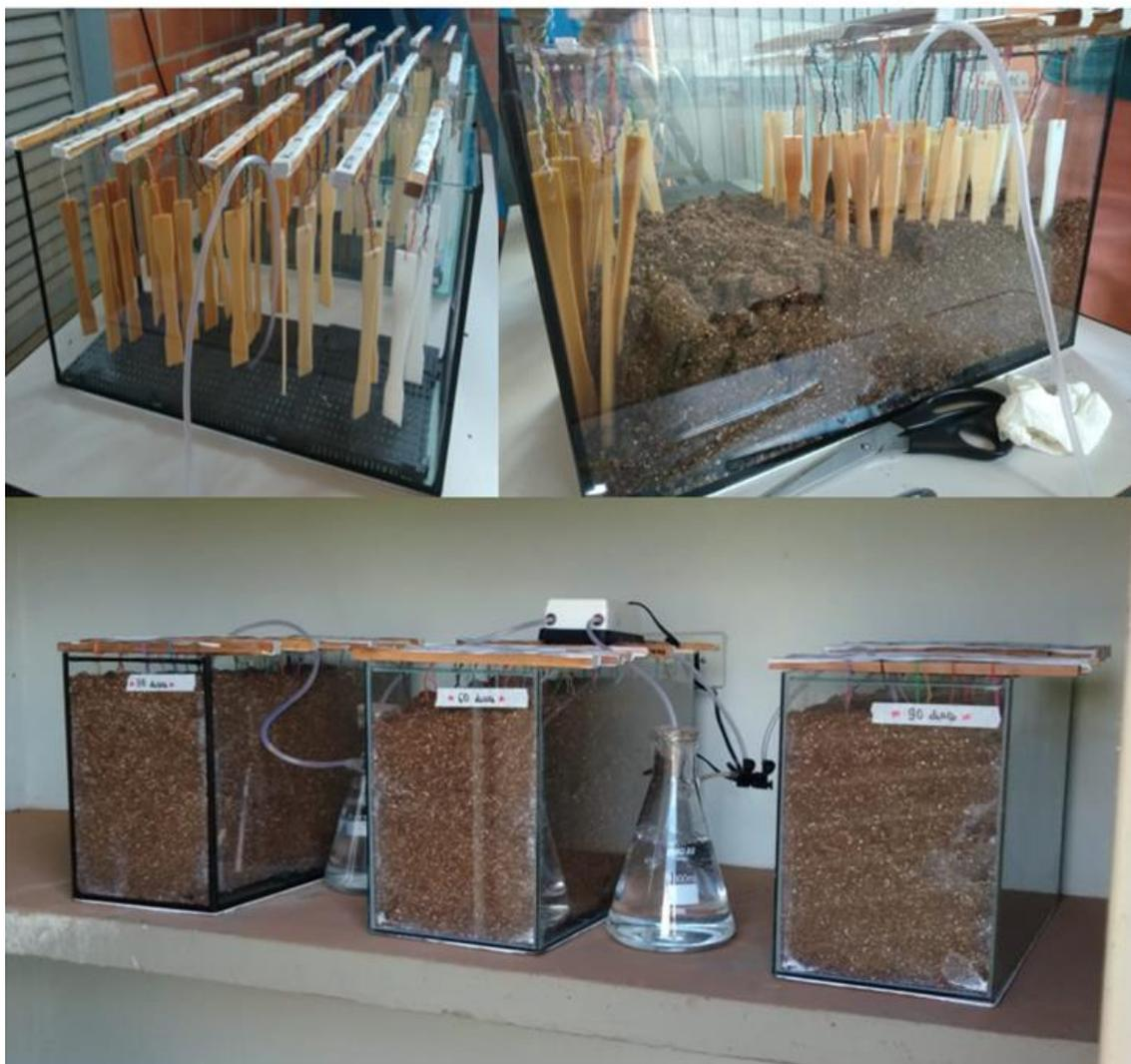
Figura 3.8 – Sistema construído para enterramento de corpos de prova.
