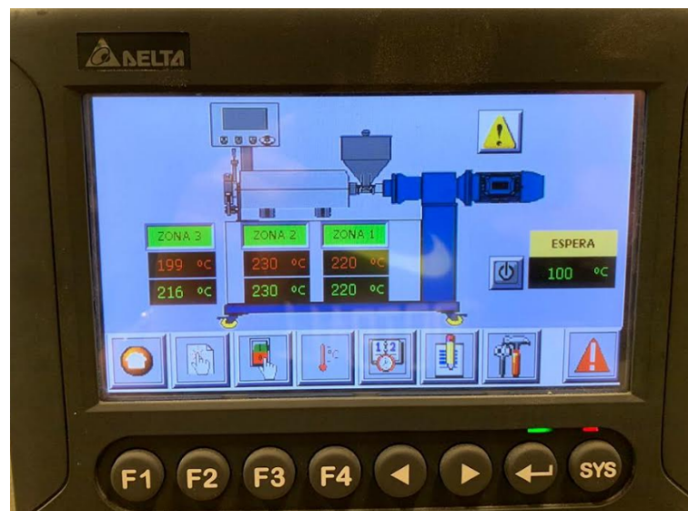
Figura 9 – IHM da extrusora e tela para setar as temperaturas das zonas.
