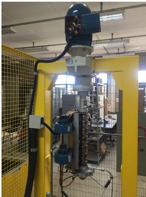
Figura 11 – Pórtico e extrusora montados no setup vertical.
