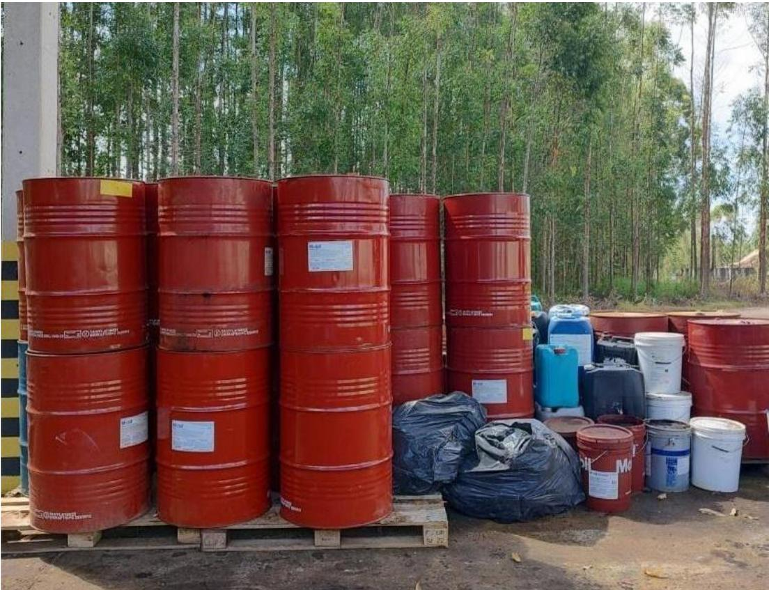
*Figura 19 - Área destinada para descarte de tambores vazios e tambores com óleo lubrificante usado.*
