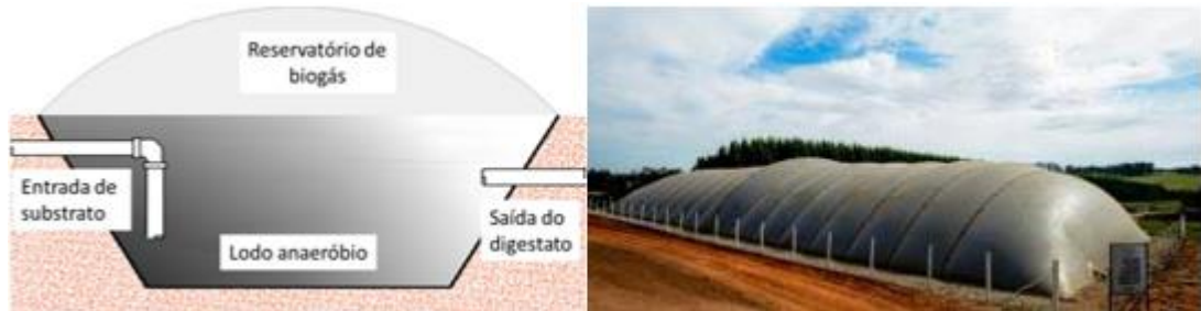
Figura 2.10.: Desenho esquemático (à esquerda) e imagem real de um CLBR (à direita)
