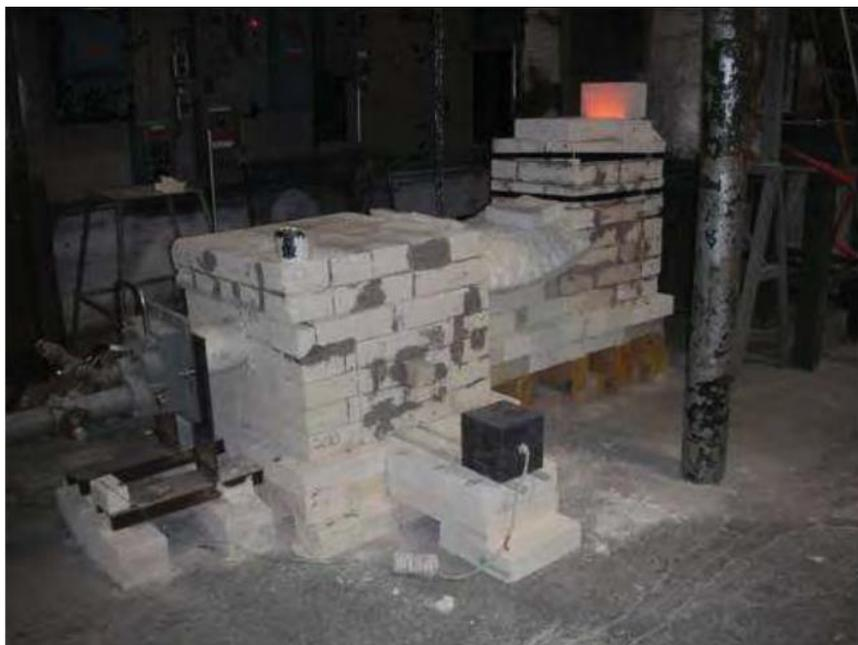
Figura A.9.1: Forno construído para o teste da tinta de alta emissividade [103].
