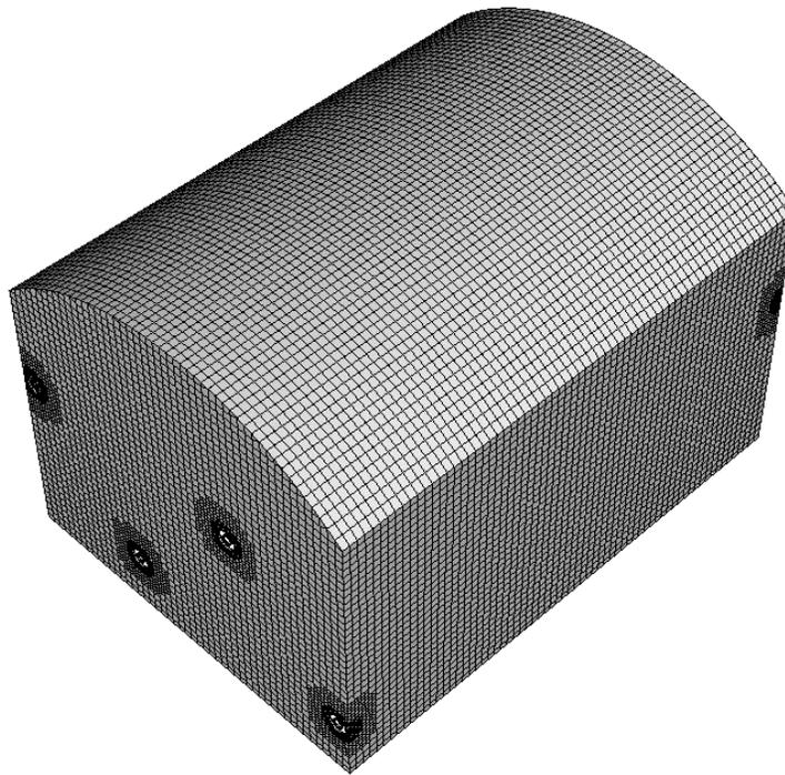
Figura 5.3: Malha híbrida de elementos tetraedrais/hexaedrais utilizada nas simulações numéricas, com refinamento nas regiões próximas aos queimadores.
