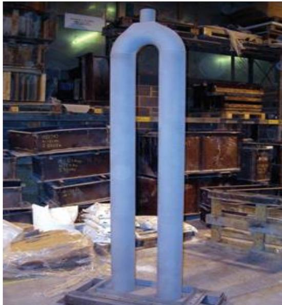
Figura 4.30: Tubo radiante no qual foi utilizado uma tinta de alta emissividade [103].
