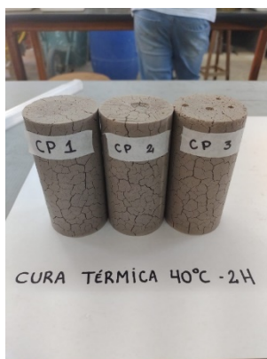
Figura 13: Teste de cura térmica com corpos de prova de pasta fissurados
