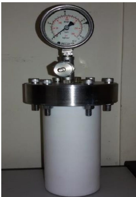
FIGURA 4.11 – Autoclave utilizada para sintetizar o MCM-41. Fonte: extraída de COSTA 65 .
