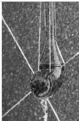
Figura 21: Como se dá a vazão do fluído de limpeza pelos bocais do cabeçote rotativo
