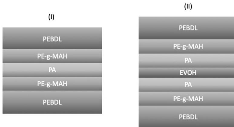
Figura 3.1. Estruturas típicas de embalagem flexível de elevada barreira a gases com 5 em (I) e 7 em (II) camadas.
