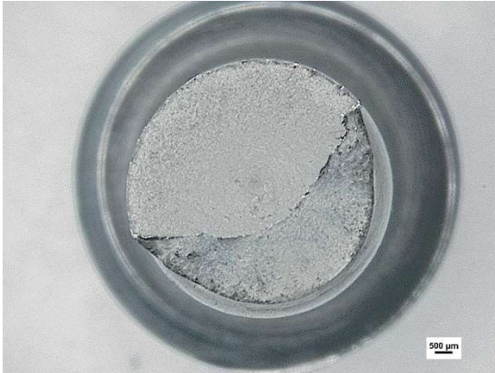
Figura 5.5.2.11 - Corrida 62. Região da fratura do CP6.
