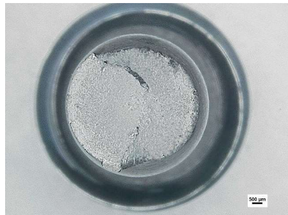
Figura 5.5.2.10 – Corrida 60. Região da fratura do CP5.
