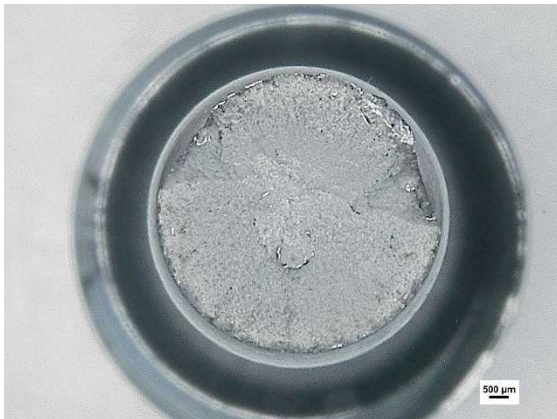
Figura 5.5.2.1 - Corrida 62. Região da fratura do CP1.
