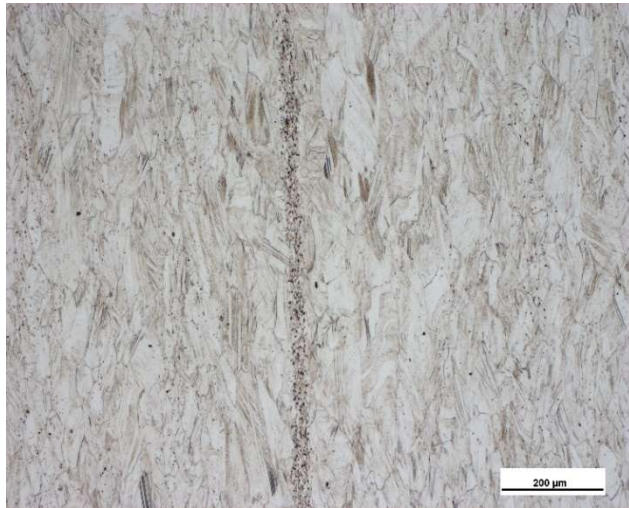
Figura 5.5.2.16 - Corrida 62. Região abaixo da fratura do CP1, com propriedades dúcteis parcialmente comprometidas pela presença de linhas de segregação. Ataque: Kalling N°2 aplicado a quente.
