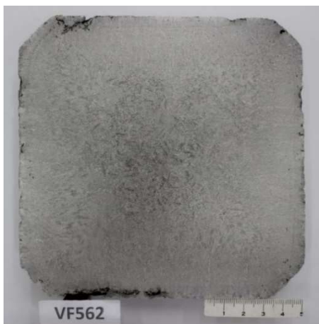
Figura 5.2.1.3 - Macrografia da corrida 59 de baixo teor de titânio. Conforme ASTM E381: S-2, R-2 e C-2.
