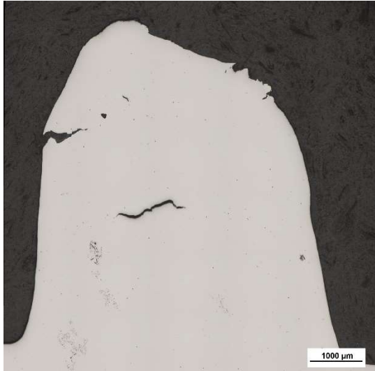
Figura 5.3.1.1 - Corrida 59, sem ataque. Seção longitudinal do corpo de prova de plasticidade ensaiado a 1050°C, mostrando rompimentos próximos à fratura.
