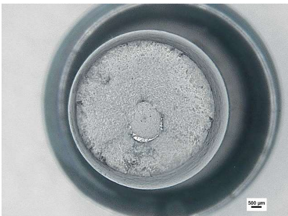
Figura 5.5.2.3 - Corrida 62. Região da fratura do CP2.
