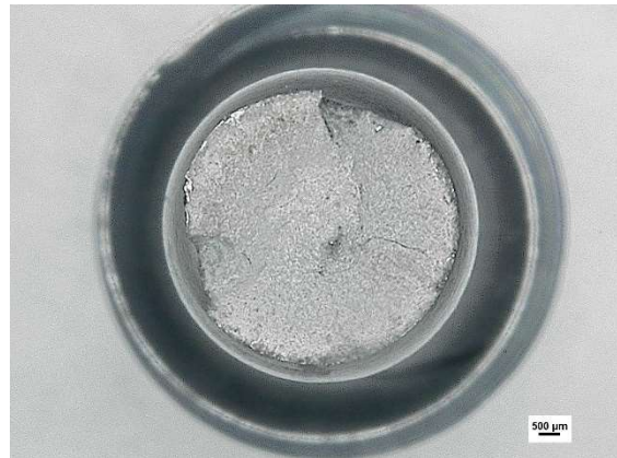
Figura 5.5.2.2 - Corrida 60. Região da fratura do CP1.
