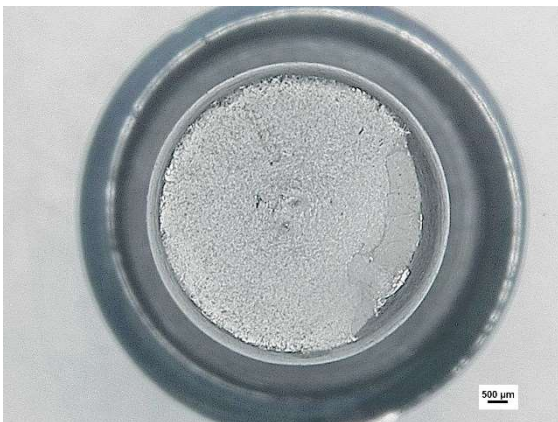
Figura 5.5.2.9 - Corrida 62. Região da fratura do CP5.
