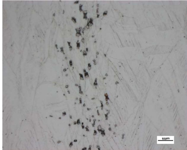
Figura 5.5.2.18 - Corrida 62. Região abaixo da fratura do CP1, mostrando a formação de vazios nos precipitados. Ataque: Kalling N°2 aplicado a quente. Magnificação: 1000x.
