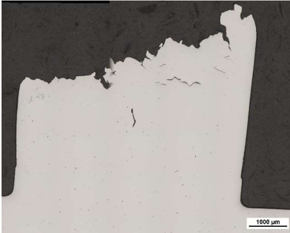
Figura 5.3.1.13 - Corrida 59, sem ataque. Seção longitudinal do corpo de prova de plasticidade ensaiado a 1200°C, mostrando alguns rompimentos próximos à fratura.
