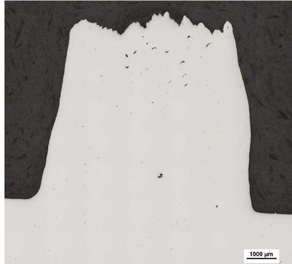
Figura 5.3.1.2 - Corrida 61, sem ataque. Seção longitudinal do corpo de prova de plasticidade ensaiado a 1050°C, mostrando rompimentos relativamente menores, próximos à fratura.
