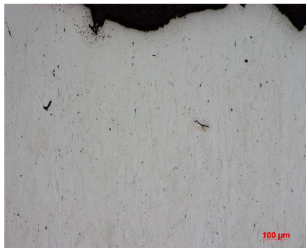
Figura 5.5.2.19 - Corrida 60. Região da Fratura do CP1, isenta de linhas de segregação. Ataque: Kalling N°2 aplicado a quente. Magnificação: 100x.
