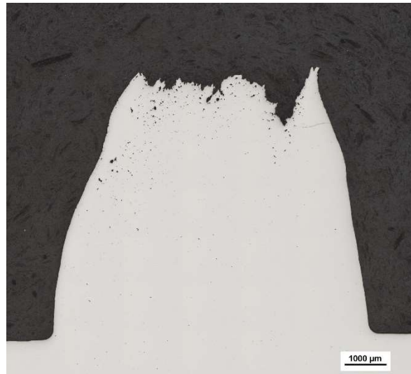
Figura 5.3.1.8 - Corrida 61, sem ataque. Seção longitudinal do corpo de prova de plasticidade ensaiado a 1150°C, mostrando a formação de vazios próximos à fratura.
