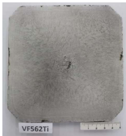
Figura 5.2.1.4 - Macrografia da corrida 61 de alto teor de titânio. Conforme ASTM E381: S-2, R-2 e C-1.
