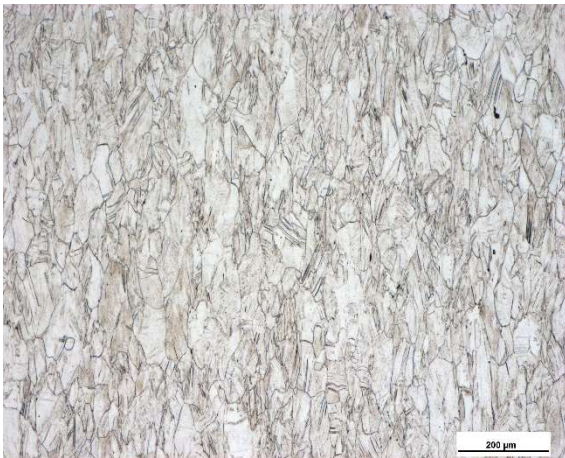
Figura 5.5.2.20 - Corrida 62. Região abaixo da fratura, isenta de linhas de segregação. Ataque: Kalling N°2 aplicado a quente.
