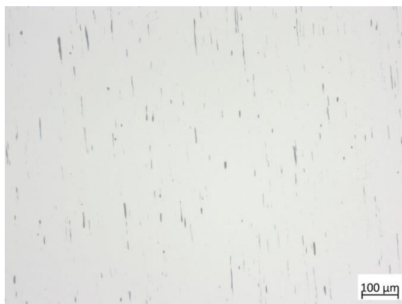
Figura 4 - Amostra do aço AISI 430F preparada para análise de inclusão. As linhas cinza escuras são os sulfetos de manganês (MnS). Fonte: Villares Metals.
