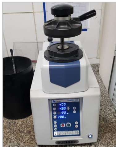
Figura 18 - Embutidora da fabricante Buehler utilizada para embutir os corpos de prova de aço.
