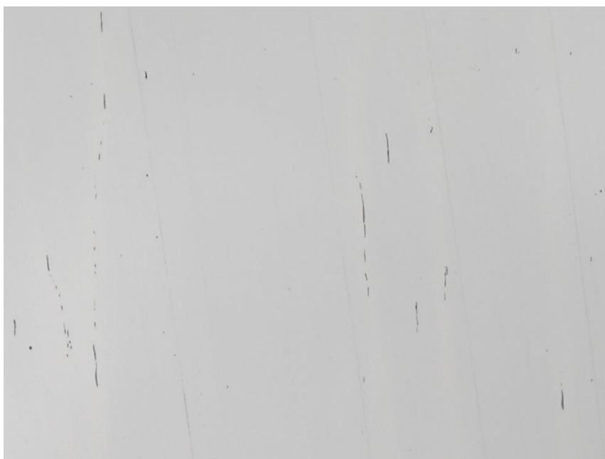
Figura 25 - Exemplo de imagem que foi excluída pela presença de riscos, os quais podem confundir a rede neural.
