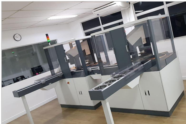
Figura 19 - Máquina de polimento automático utilizada para realizar o polimento dos corpos de prova de aço.
