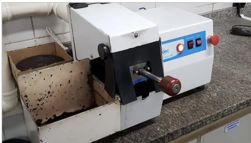
Figura 16 - Equipamento cut-off utilizado para realizar o corte dos corpos de prova de aço.
