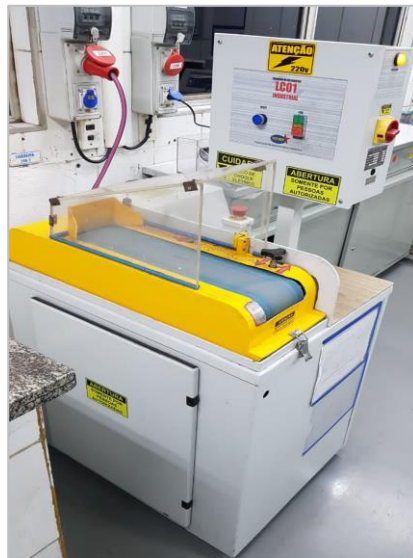
Figura 17 - Lixadeira tipo correia com lixa 100 utilizada para lixar os corpos de prova de aço.
