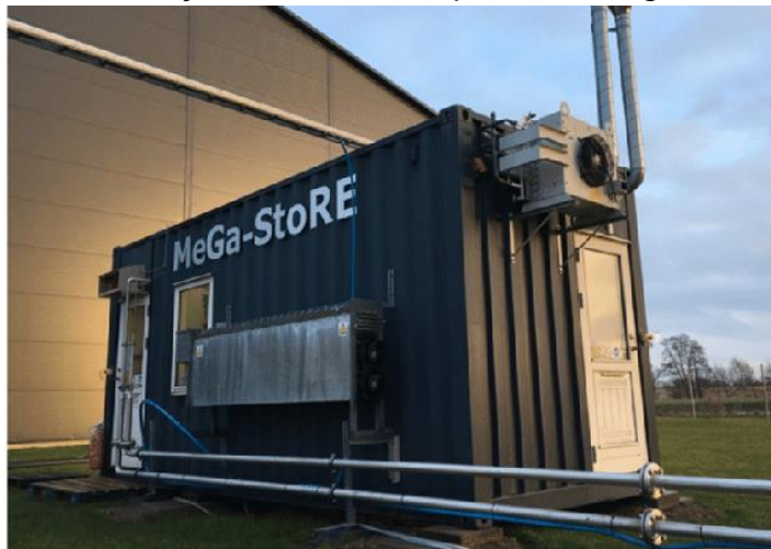
Figura 2.13 - Container MeGa-StoRE para obtenção do metano a partir do biogás
