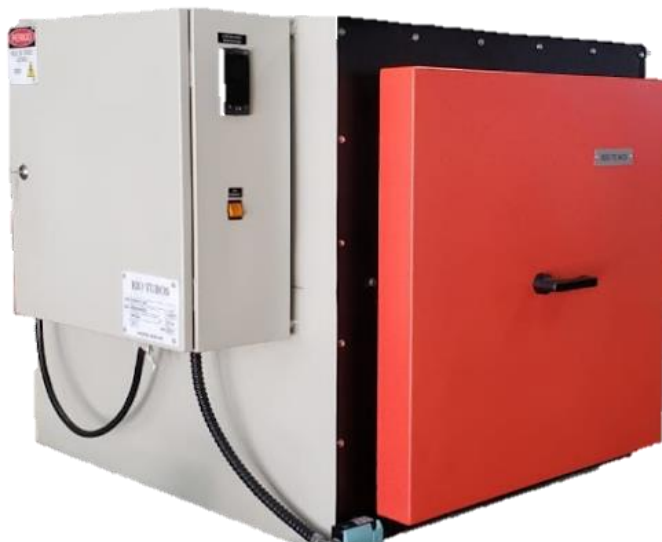
Figura 38 - Forno mufla Metaltrend K-150 utilizado nos ensaios de pirólise
