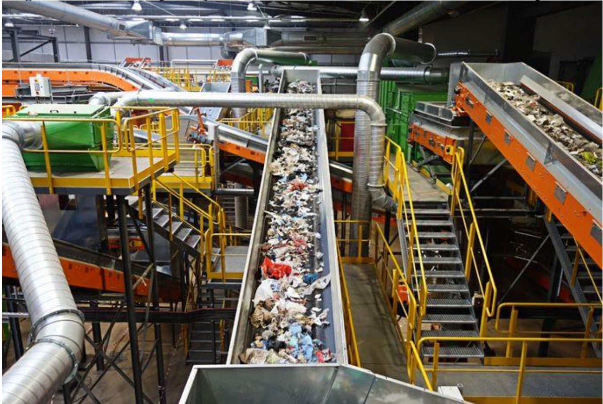
Figura 17 - Planta de produção de CDR: esteiras alimentadoras no início do processo
