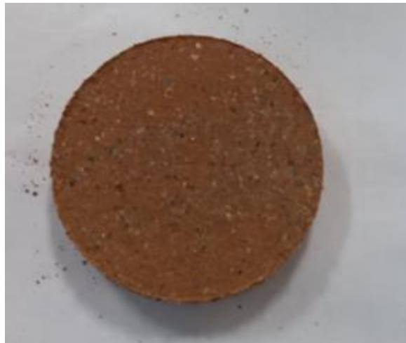
Figura 37 - Amostra de CDR-01 e resíduo de bauxita já misturados na proporção de 50% cada
