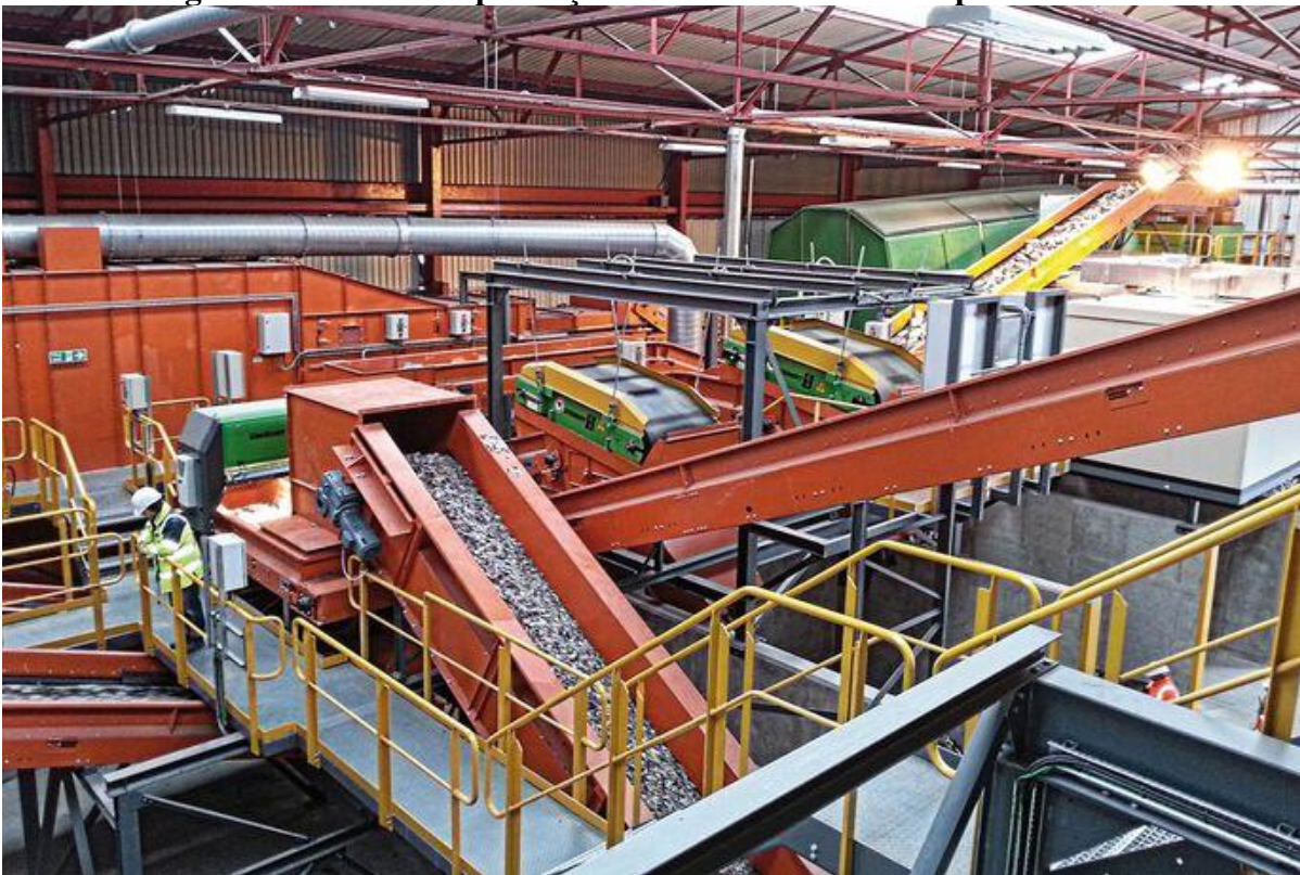
Figura 18 - Planta de produção de CDR: esteiras com produto final
