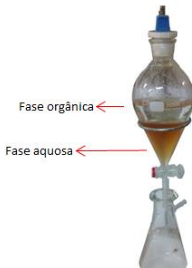
FIGURA 4.1.3 – Lavagem da fase orgânica após a troca aniônica para obtenção do LI hexafluorofosfato de 1-Butil-2,3-dimetilimidazolina - [BMMIM]PF 6 .
