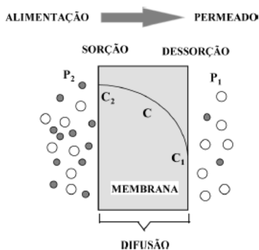
FIGURA 2.2.2 – Ilustração do transporte através de uma membrana densa (HABERT, BORGES E NOBREGA, 2006).
