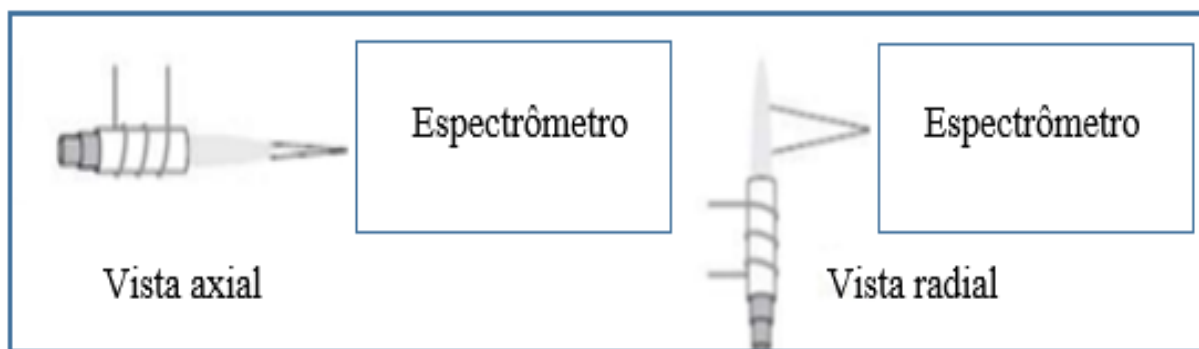
FIGURA 6 – Configurações de uma fonte de plasma, axial e radial.
