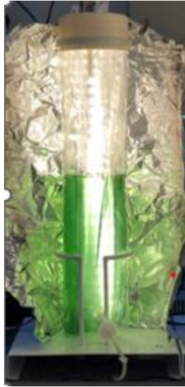
Figura 1: Fotobiorreator (FBR) desenvolvido no Laboratório de Biotecnologia de Algas, UFSCar.
