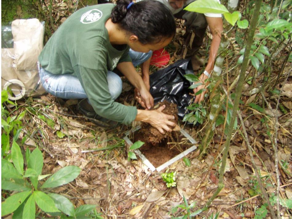
Figura 20. Amostrador metálico utilizado para coleta de solo e serrapilheira no cerrado da Estação Ecológica de Assis, SP.
