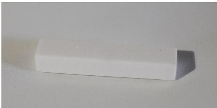
Figura 5.31. Aspecto final da amostra de Quartzo/Vidro sinterizada.
