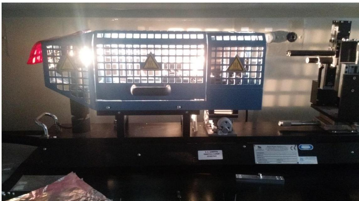
Figura 4.6. Dilatômetro óptico utilizado para obtenção de curvas de dilataometria.
