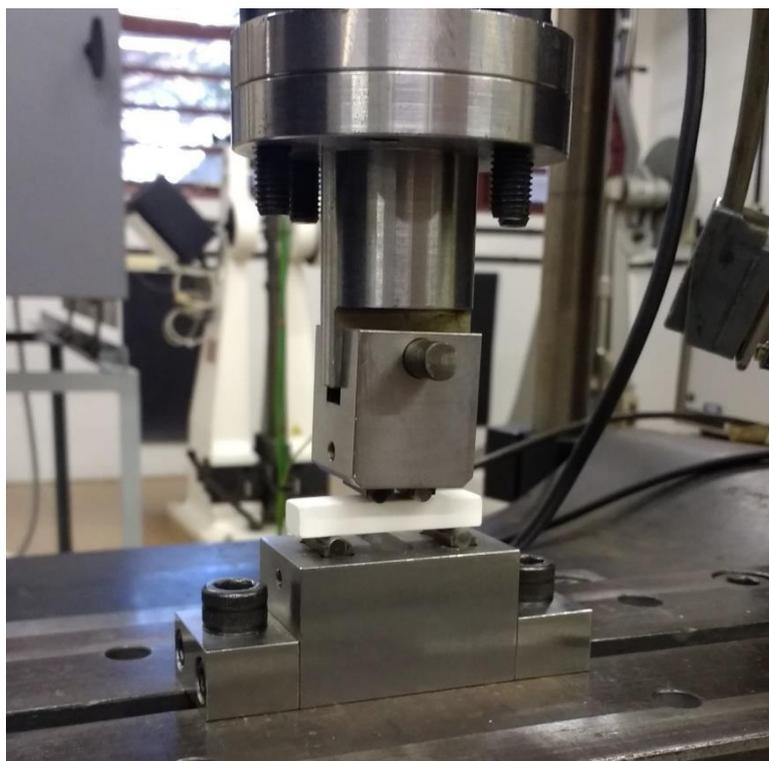
Figura 4.8. Dispositivo utilizado para medição da resistência à flexão das amostras de compósitos vidro/minerais. No detalhe, amostra de alumina/vidro de janela submetida ao teste.
