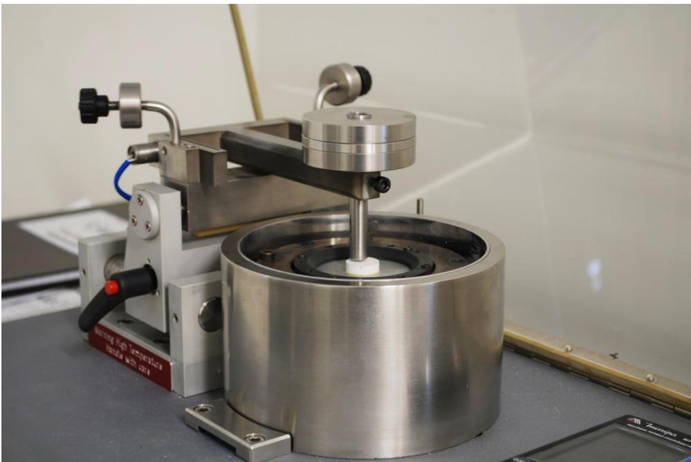
Figura 4.10. Tribômetro utilizado para testes de pino sobre disco.
