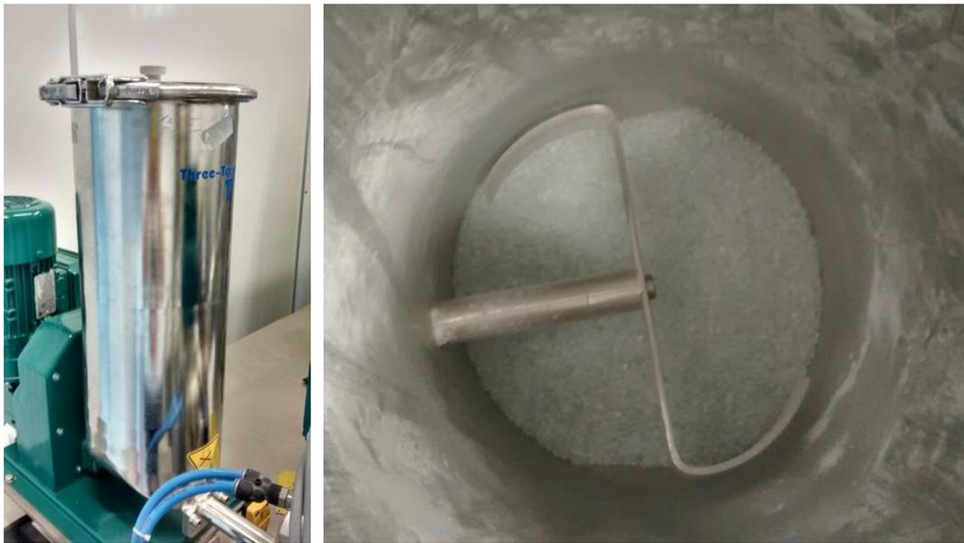
Figura 4.3. Moinho jet mil da Netzsch – Condux – MahltechnikGmbH (à esquerda) e detalhe da moagem (à direita).
