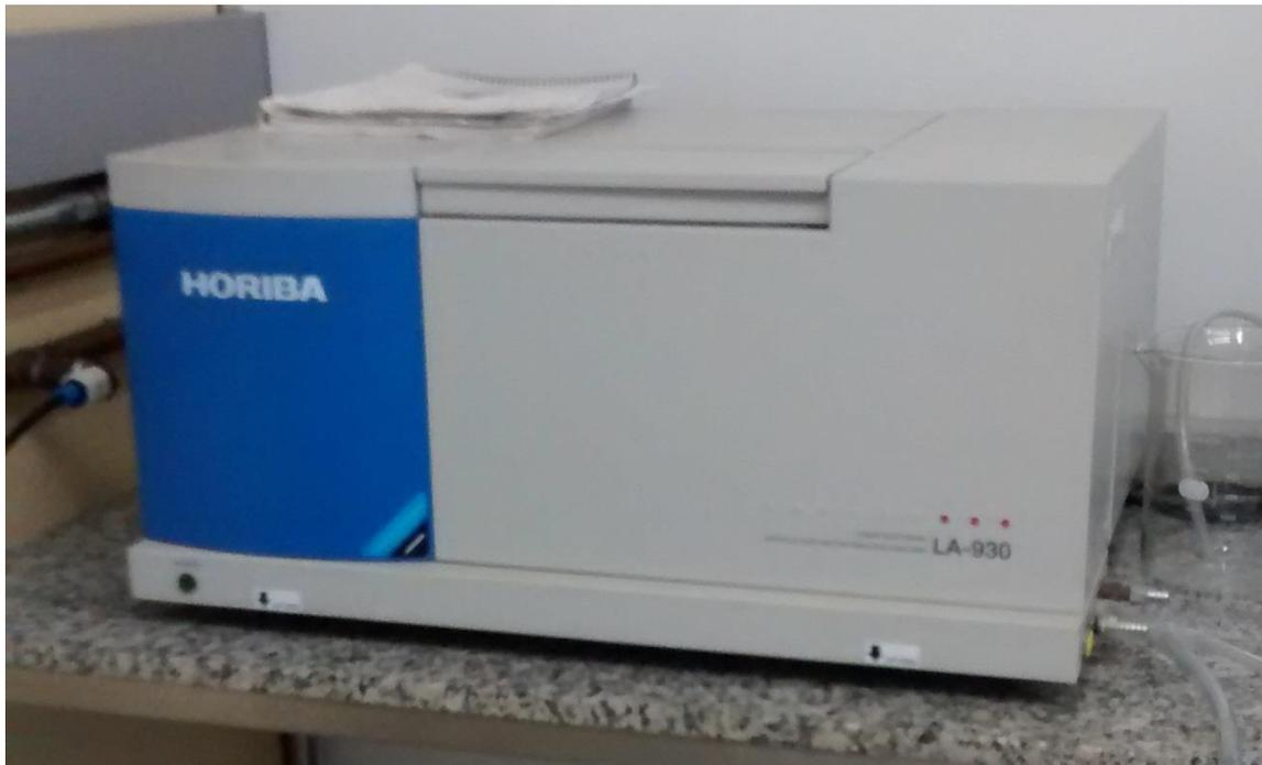
Figura 4.5. Analisador de tamanho de partículas a laser.
